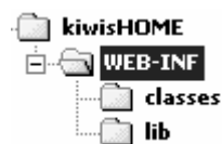
Figure 3.7 structure minimale imposée d'une application Web
